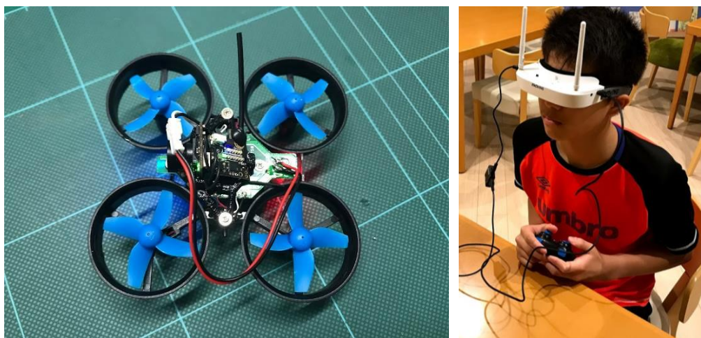
図 小型カメラ一体型VTXを搭載したマイクロドローンとFPVゴーグルを使用した操縦
